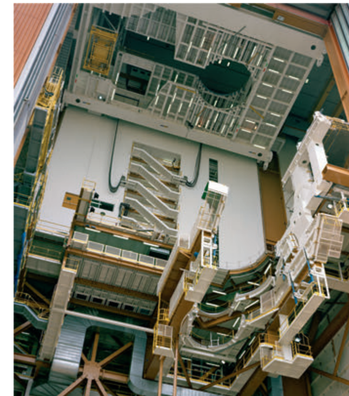
↑ Visszhangmentes terem az EADS Astrium vállalat toulouse-i létesít- ményében, mely a világűr csendjének és életteleniségének szimulálá- sára használatos a műholdak fellövését megelőző tesztelés során.
